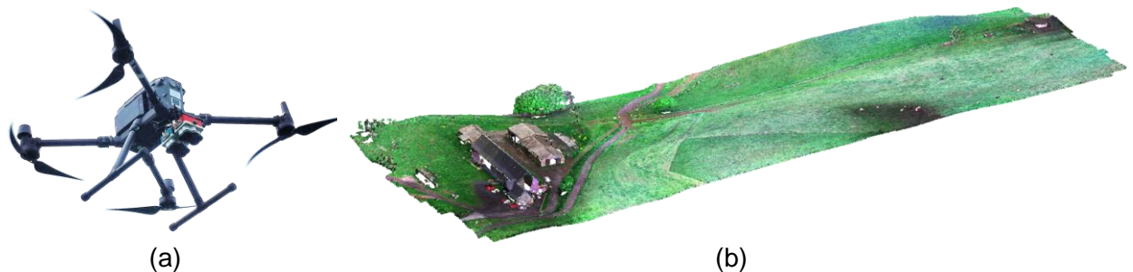
Figure 3 : Perception de l'environnement par drone. (a) Vue générale d'un drone en vol. (b) exemple d'une reconstruction 3D de l'environnement par photogrammétrie.
