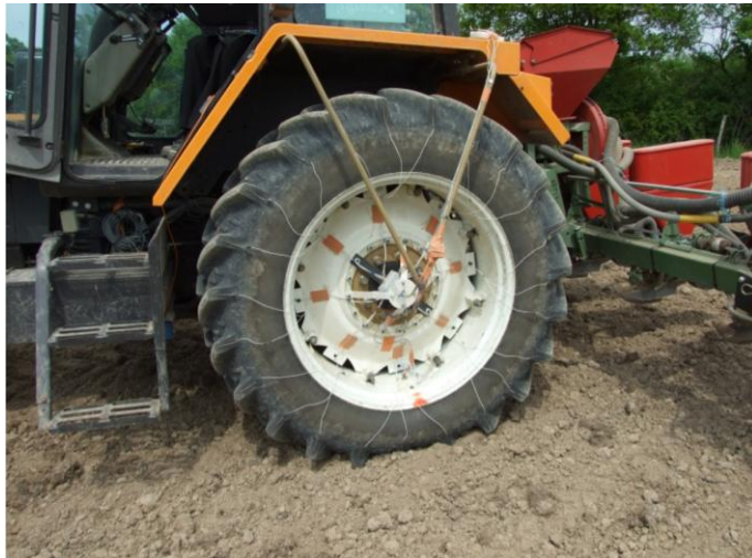
Figure 2 : Pneu-capteur permettant la mesure de la déformation du pneumatique et de l'impédance du sol
