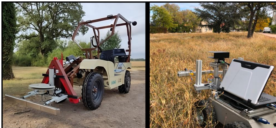
Figure 1 : Exemple de robots équipés de pare-chocs sensibles pour la détermination de traversabilité
